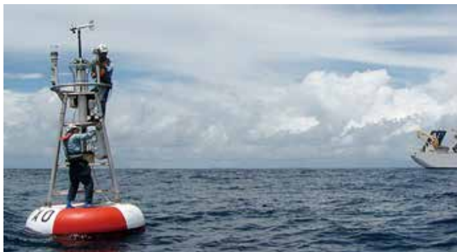
技术人员在为NOAA配有二氧化碳传感器的浮标上工作。这类自治传感器改进了对海洋每年储存多少碳的估算。（来源：NOAA）
