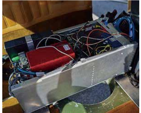
位于飞机驾驶舱内，在一个开放式相机端口上方的机载高光谱成像仪（G-LiHT）使得它在大约1000英尺（304.8米）高空，以大约150英里/小时飞行速度，向下俯瞰。
